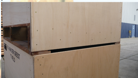
Kier tussen twee kisten waar de lucht uit de kist kan ontsnappen
