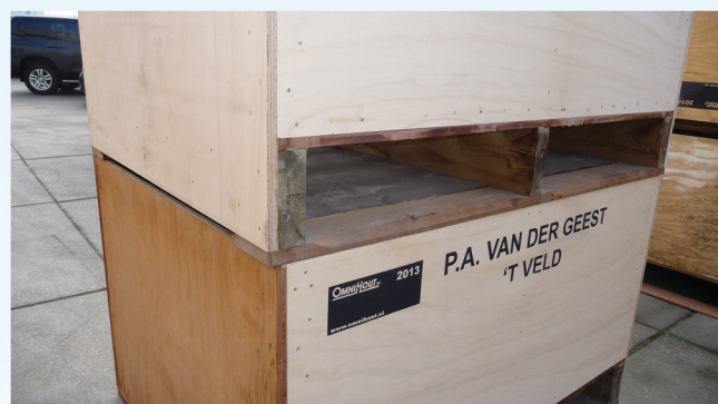
Deze bloembollenkisten hebben een dichte palletbodem. Geschikt voor 1-laagsventilatie.
