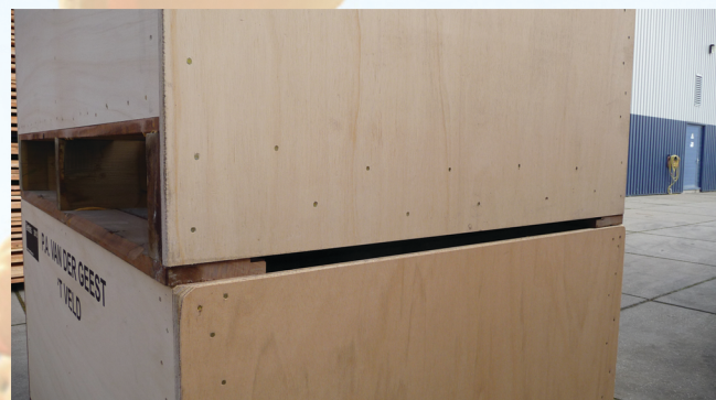
Door de opening aan de zijkant van de kist wordt de lucht naar buiten afgevoerd.
